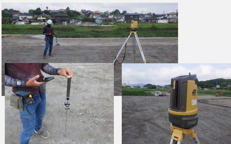
自動追尾式TSと接続しリモートキャッチャー（プリズム）の使用した作業状況
