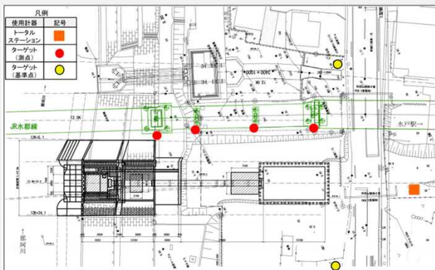
ターゲットプリズムによる動態観測図
