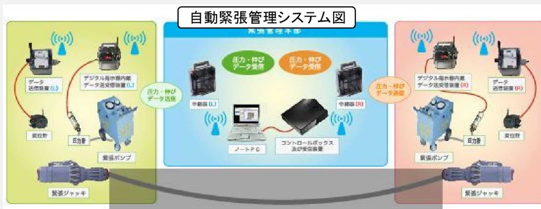
自動緊張状況 (自動緊張管理システム使用状況)
