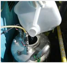
① マーカー車に搭載した専用タンクに硬化液を充填
