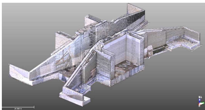
3次元測量から得られた点群データモデル
