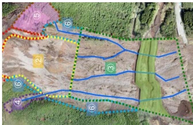
図 54 排水工位置決定のための水文解析、滞筋を抽出し水路工を検討した例
