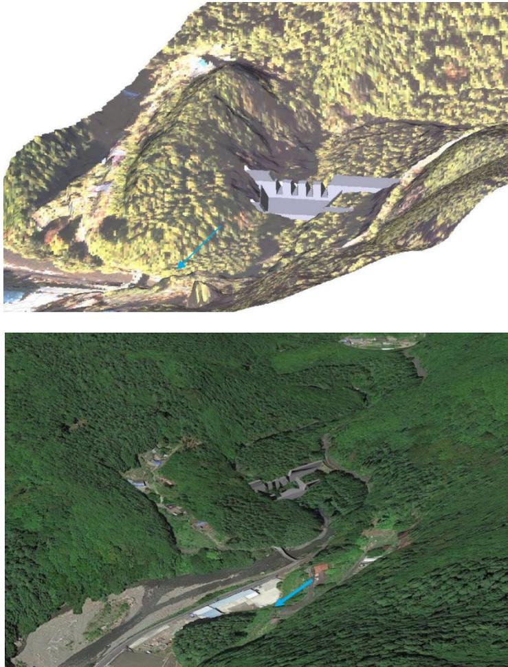
図 17 施設設計検討において活用するBIM/CIMモデルの例(1)(詳細度:300)
