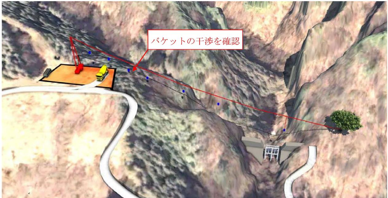
図 29 施工計画及び仮設構造物設計において活用する BIM/CIM モデルの例（2）（詳細度：300）
