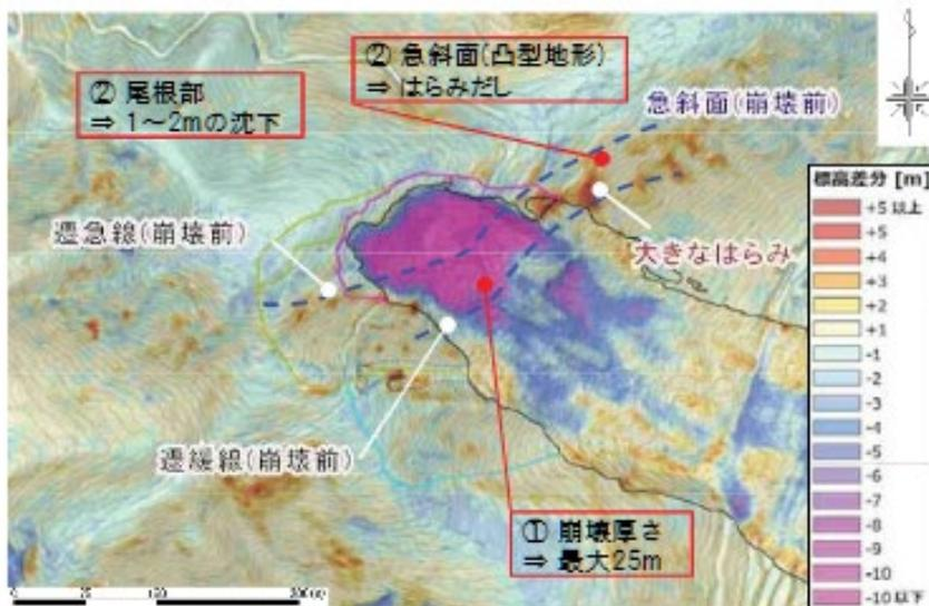
図 50 頭部排土および斜面の土砂移動状況の把握、差分解析図の例
