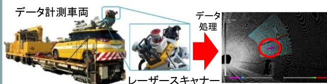
3次元点群データによる変状の検出例
