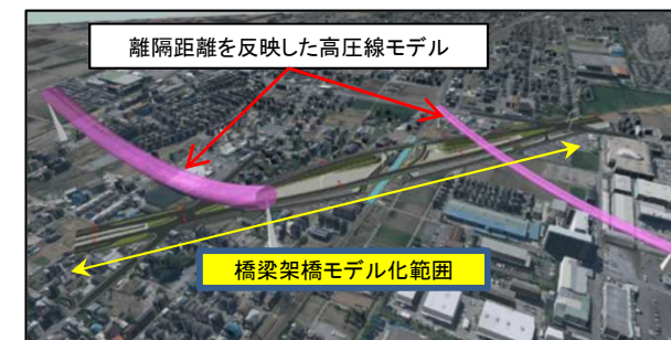
橋梁と架空線の離隔確認
