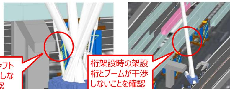
桁架設時の架設桁とブームが干渉しないことを確認
