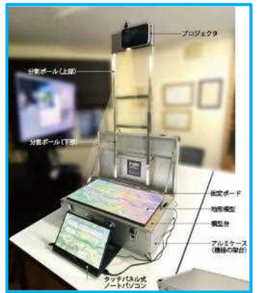
プロジェクションマッピングの投影面に活用 (公開データを3Dプリンターで出力)
