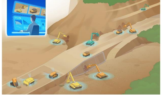
1人のオペレータが遠隔で複数の建機を稼働
