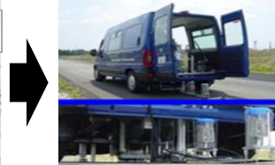
FWDによる健全度診断
