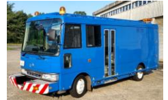
移動式たわみ測定装置
