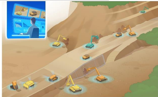
1人のオペレータが遠隔で複数の建機を稼働
