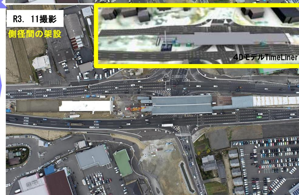
これまでの取り組み：BIM/ CIMモデルに時間軸を追加し施工ステップを表現することにより、重機や仮設材の配置を確認しリスクを可視化し施工計画へ反映。
