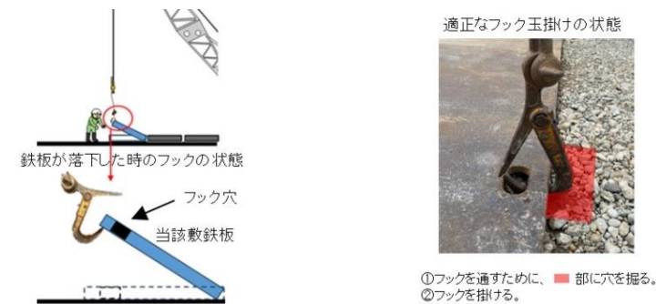
図 事故時の玉掛け状況(左)・適切な玉掛け状況(右)
