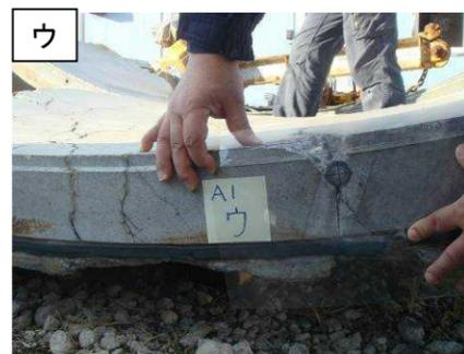
④リング継手(切羽側：ボルトボックス)
