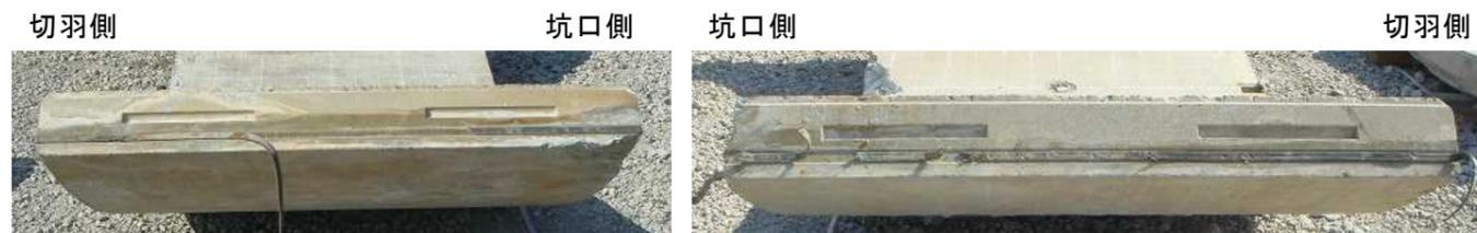
③リング継手 (坑口側：埋込みインサート)
