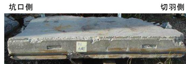
③リング継手(坑口側：埋込みインサート)
