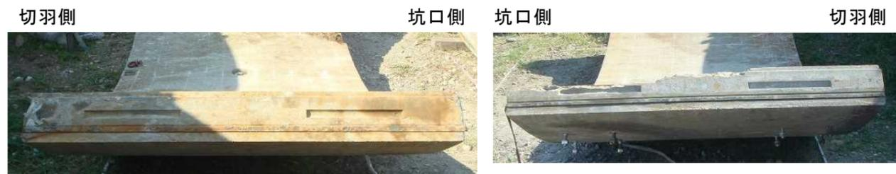
③リング継手(坑口側：埋込みインサート)
