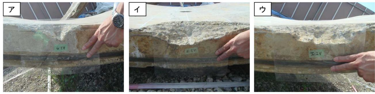
④リング継手 (切羽側：ボルトボックス)
