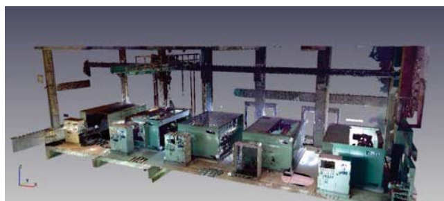
図 43 点群による現地調査図
