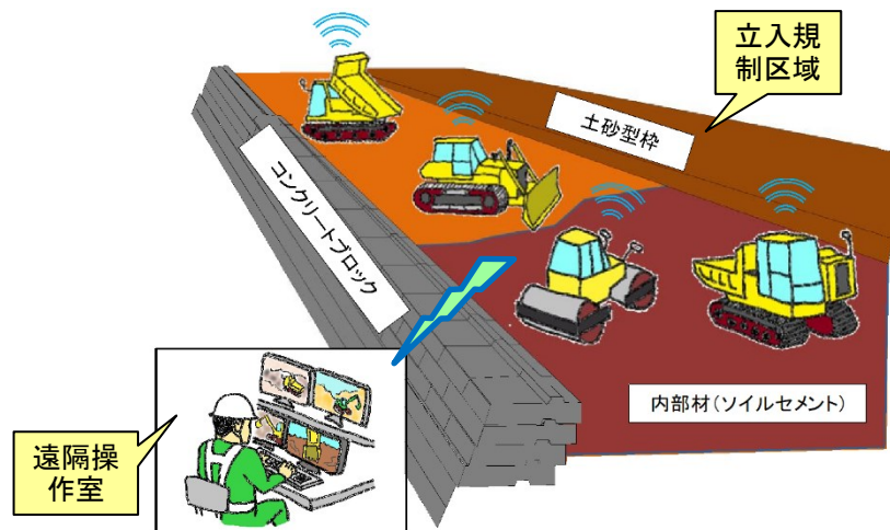
図-2-8-1 赤谷 3 号砂防堰堤の無人化・自動化施工
