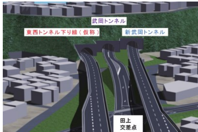
図-2-11-1 鹿児島東西道路シールドトンネル下り線
