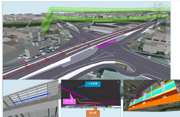
図-2-6-3 BIM/CIM を用いた占用物等確認
