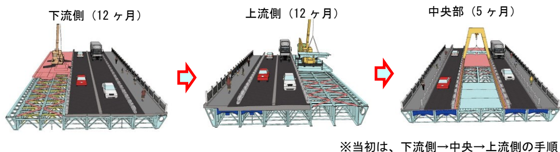
図-2-1-1 淀川大橋床版取替の施工手順
