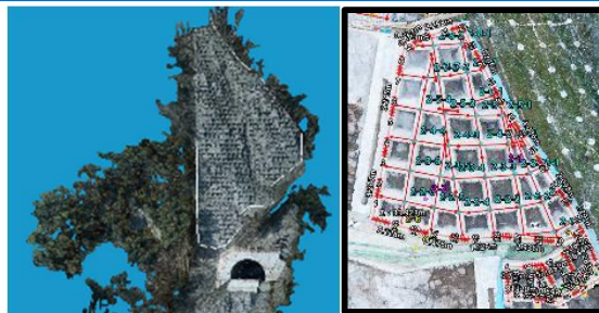
3次元データによる法枠の出来形確認
