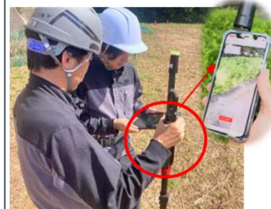
モバイル端末による3次元計測
