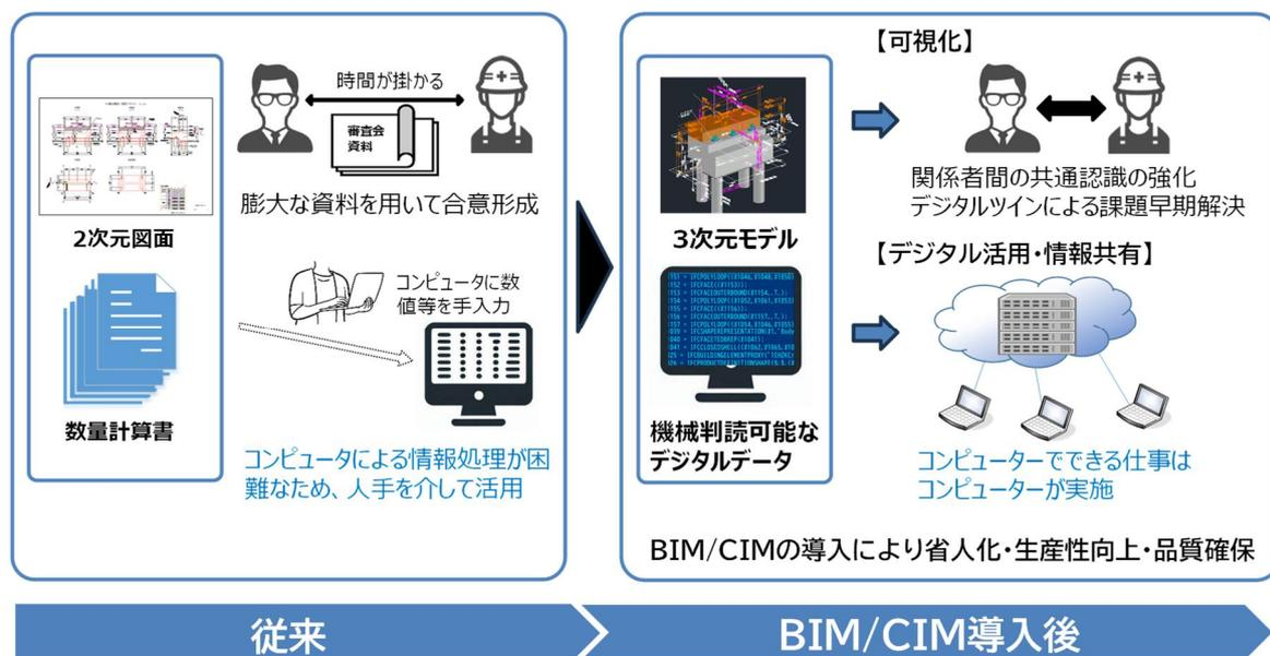
図 - 2 BIM/CIM で目指す仕事の効率化
