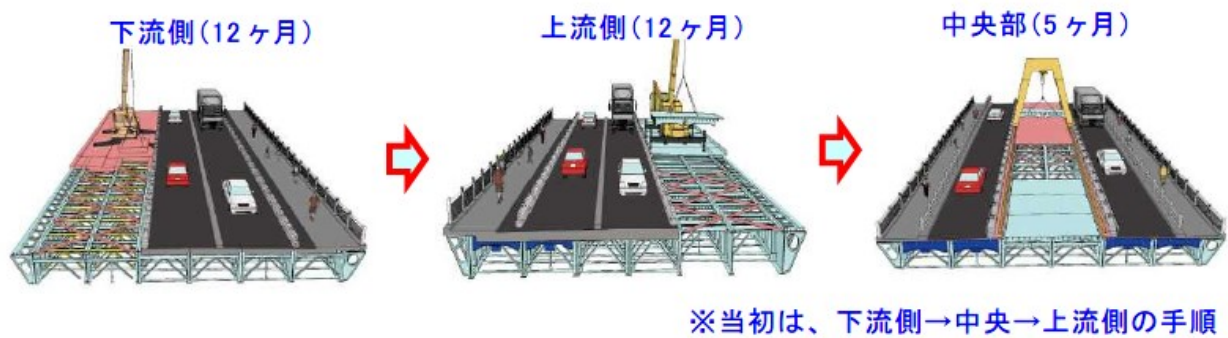
図 採用した施工手順
