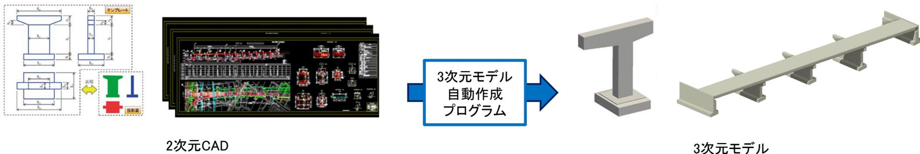
【橋梁の2次元CADから3次元モデルを作成】
