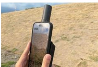
※viDoc RTK roverは、viGram社製のGNSSレシーバになります。
