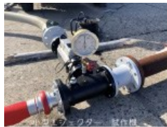
エンジンポンプとエジェクターを連結した小型可搬式システム
