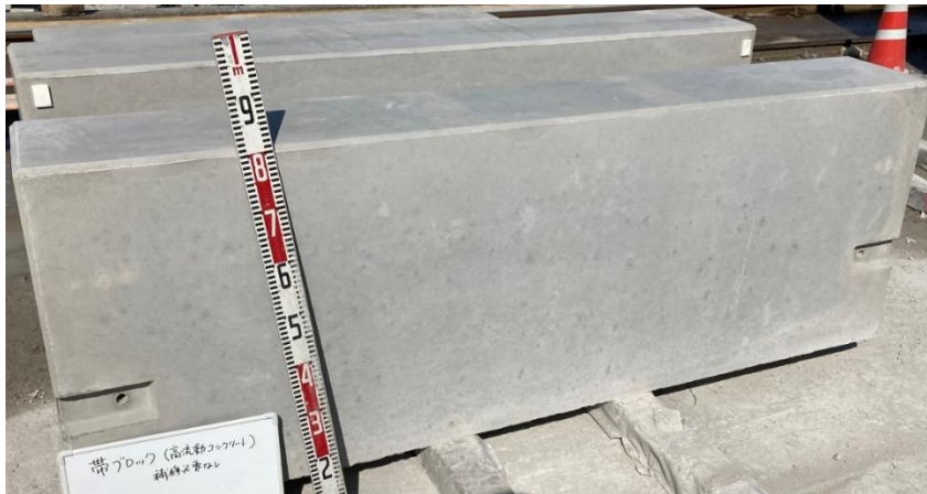
写真 5-1 合格製品(高流動コンクリートを使用)
