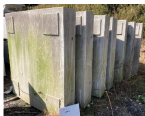
写真 5-5-1 長期保管による汚れ
