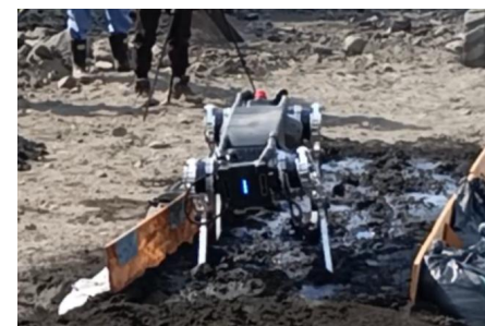
火山灰堆積時の走行試験状況 (降灰10cm、勾配なし、湿潤状況)
