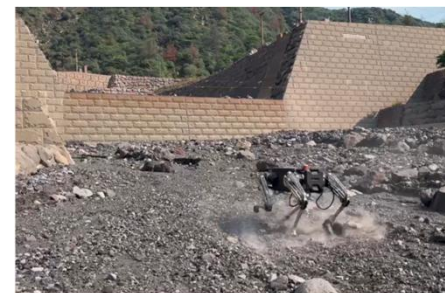
溪流内の悪路走行試験状況②
