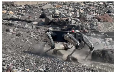
溪流内の悪路走行試験状況①
