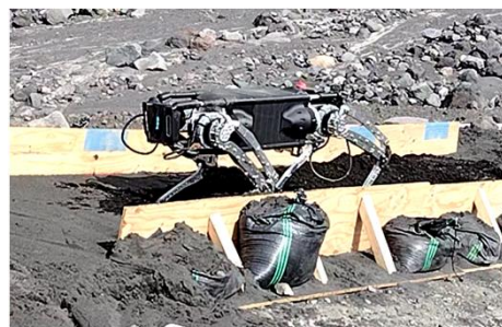
火山灰堆積時の走行試験状況 (降灰10cm、勾配約15°)
