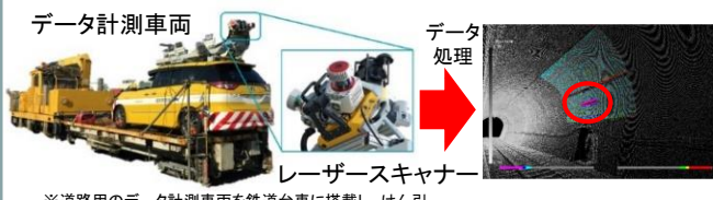
3次元点群データによる変状の検出例
