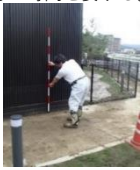
技術者が洪水痕跡を現地で調査
