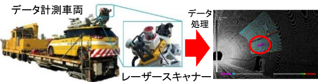
※道路用のデータ計測車両を鉄道台車に搭載し、けん引 3次元点群データによる変状の検出例
