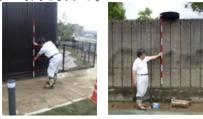
技術者が洪水痕跡を現地で調査
