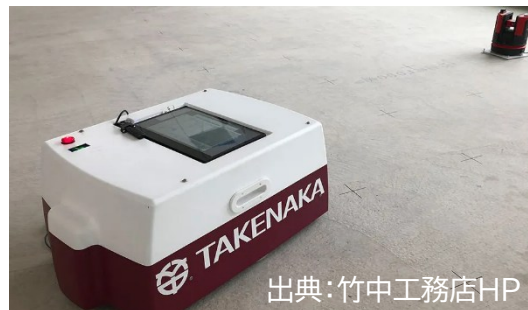
建築現場における墨出しロボットの例
