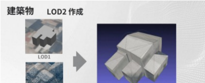
建築物LOD1と航空写真・DSM(数値表層モデル)からLOD2自動作成
