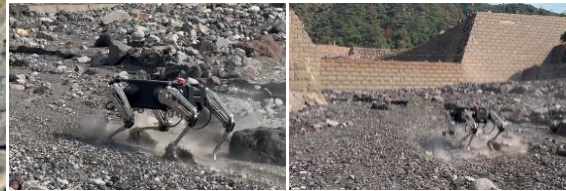
【写真】溪流内の悪路走行試験状況
