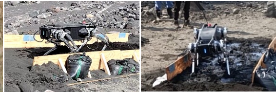
【写真】火山灰堆積時の走行試験状況
