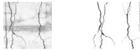
図-2 画像計測によるクラックの検出 (左：原画像，右：検出されたクラック)
