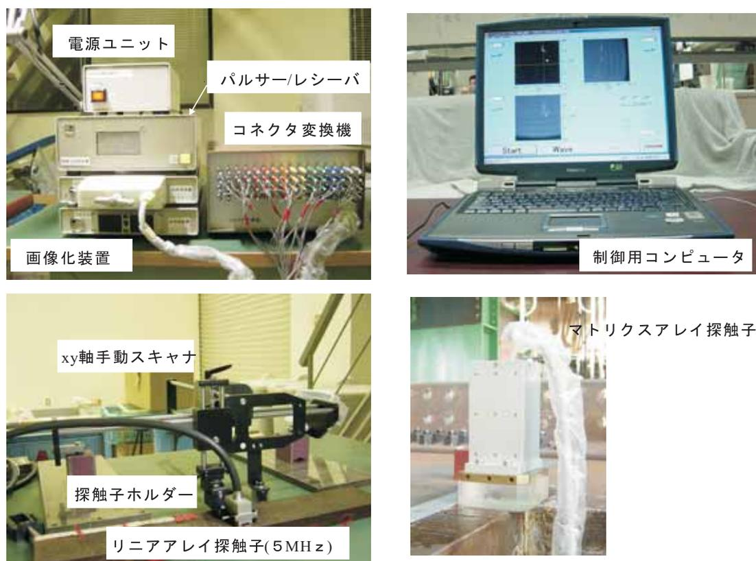
図 3.1: 実験に用いたアレイ探傷システム
