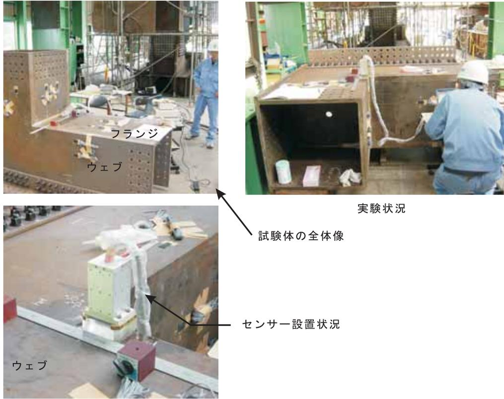
図 4.17: 試験体および計測状況
