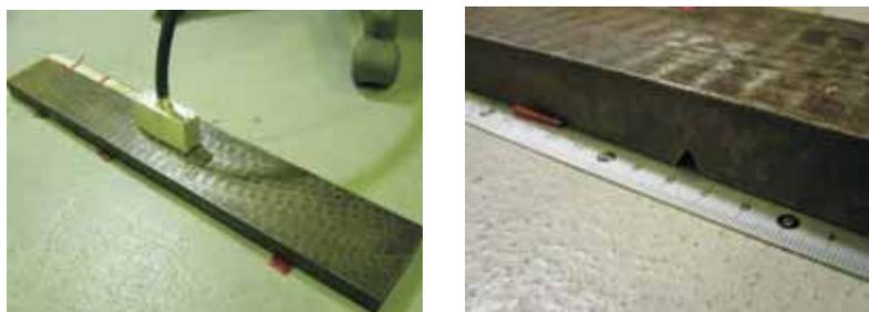
図 3.5: V 字ノッチ試験体
