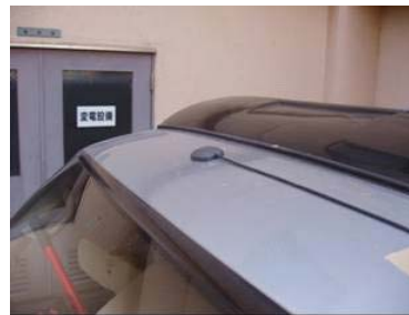
図 2-14 アンテナ設置状況
