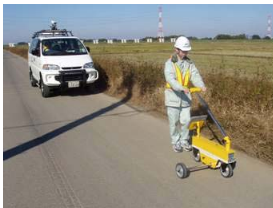
図 3-14 DAM を用いた路面形状計測状況
