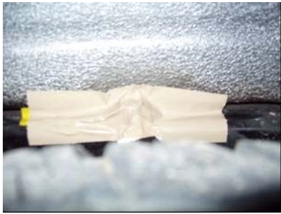
図 2-10 左後ばね上加速度計設置状況
