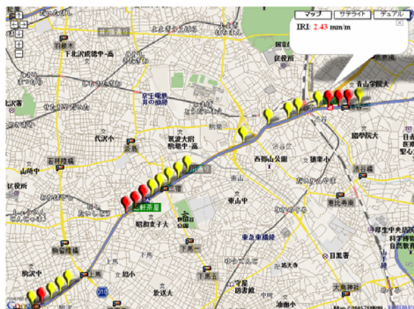
図 6-24 渋谷線渋谷付近での悪い舗装
