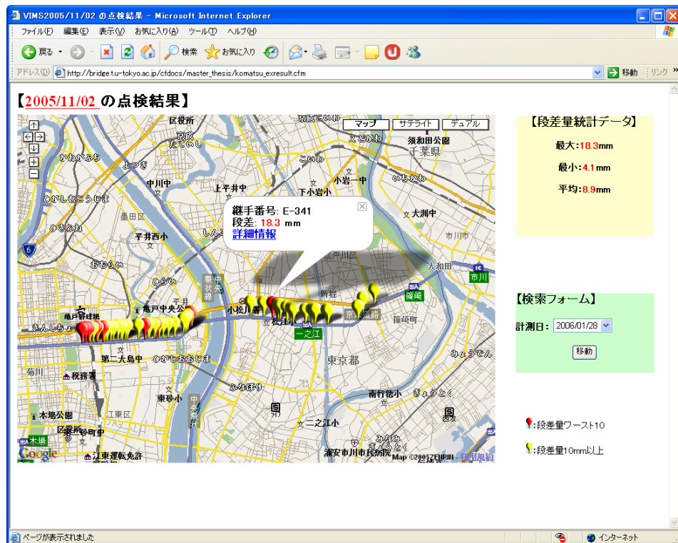
図 6-5 11 月 2 日の段差量異常箇所地図表示
