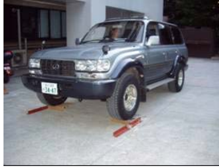
図 3-4 試験時の状況（ピッチング振動）
