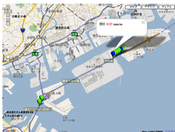
図 6-31 湾岸線東扇島付近でのよい舗装
