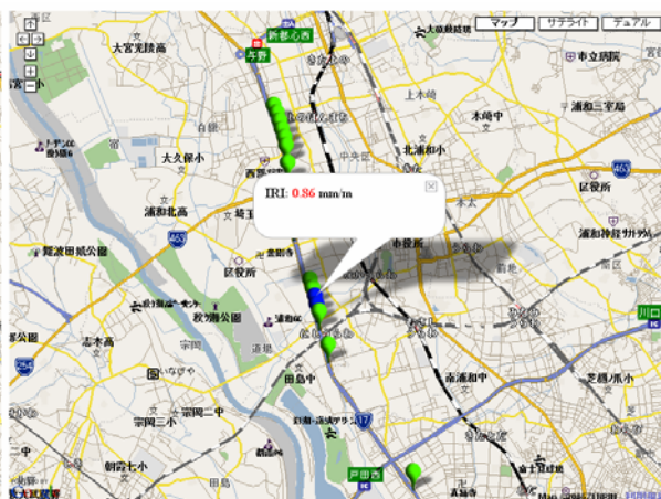
図 6-21 大宮線西浦和付近でのよい舗装
