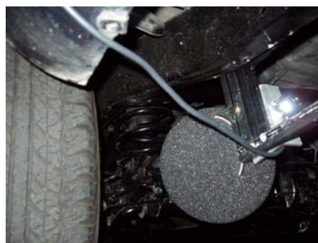
図 2-18 マイクロフォン設置状況
