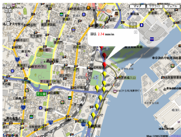
図 6-18 都心環状線浜崎橋 JCT 付近での悪い舗装
