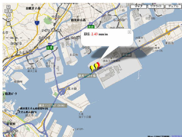
図 6-25 湾岸線鶴見つばさ橋付近での悪い舗装
