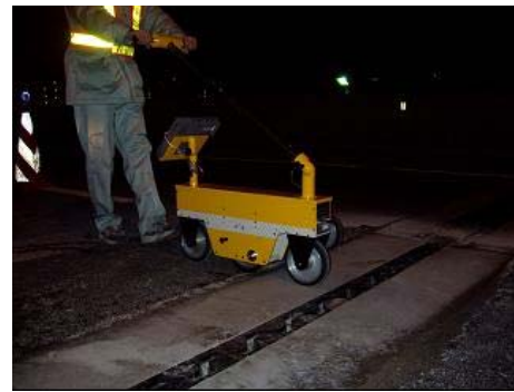
図 4-41 伸縮装置部形状計測状況
