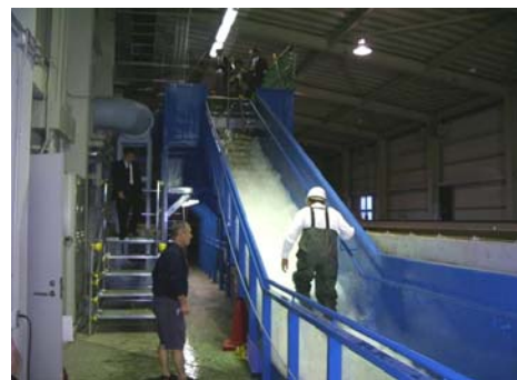
図6 階段模型による避難実験
