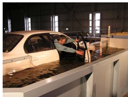
図9 車模型による脱出実験
