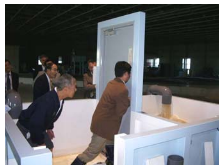
図8 ドア模型による避難実験
