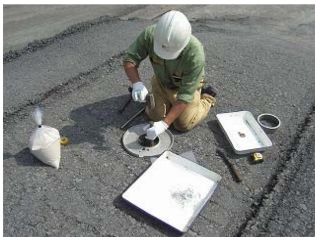
写真-3.6 現場密度測定 試料採取状況
