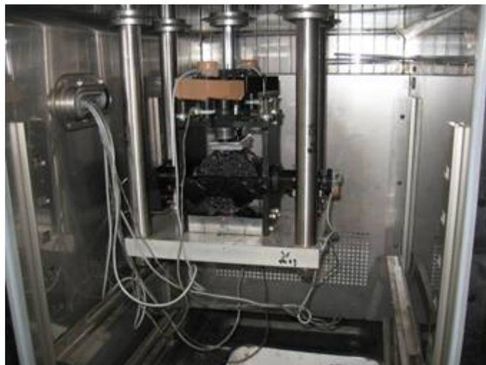
写真-5. 7 基層混合物のレジリエントモデュラス値測定状況
