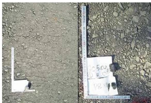
(a)後輪振動4回後 (b)後輪振動8回後
