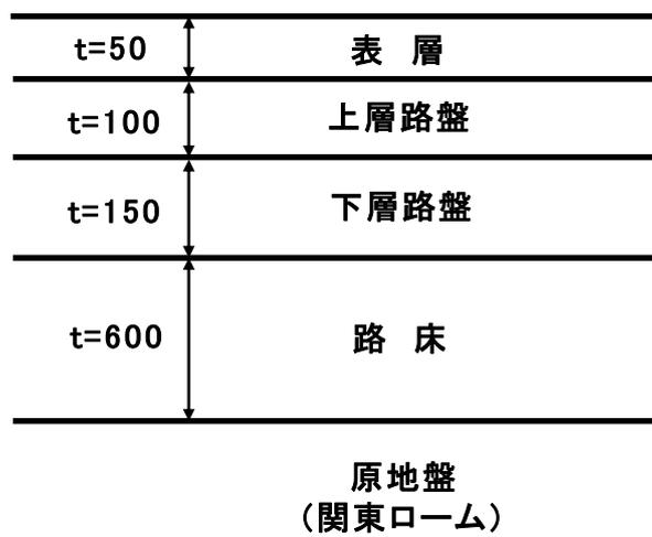
図-3.3 試験施工断面
