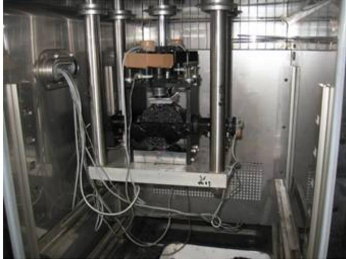
写真-3. 7 基層混合物のレジリエントモデュラス測定状況
