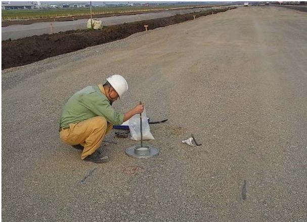
写真-5.5 現場密度測定試験状況
