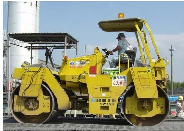
写真-3. 2  $\alpha$ システム装着振動ローラ
