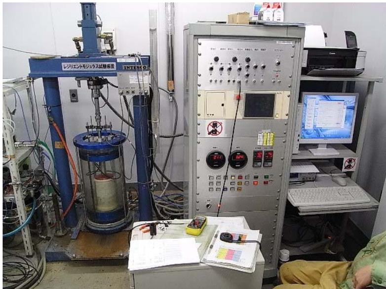
写真-5.8 路盤材・路床土のレジリエントモデュラス値測定状況
