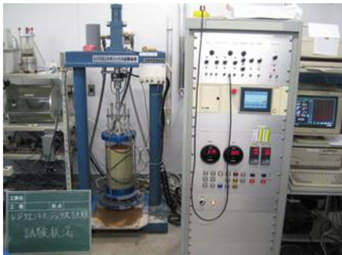
写真-3. 8 路盤材・路床土のレジリエントモデュラス測定状況
