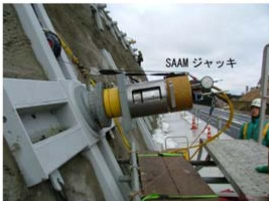
図7.2.7.1 SAAMジャッキによるリフトオフ試験
