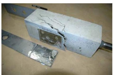
d) 接着幅  $B=70\text{mm}$
