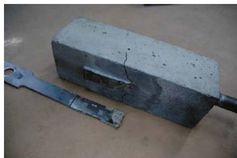
a) 接着幅  $B=30\text{mm}$
