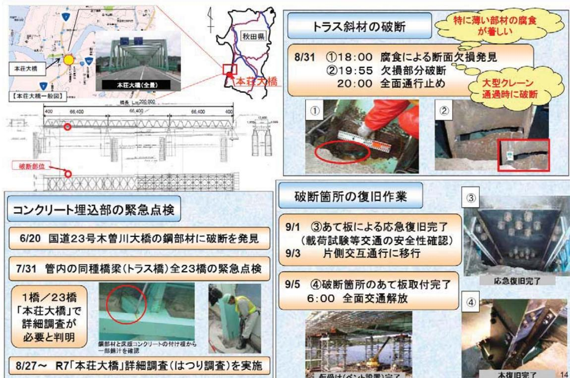
図-1.3.4 本荘大橋のトラス斜材の破断 [14]
