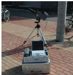
写真-2.3.1 レーザードップラ速度計
