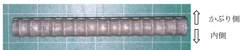
写真-8.3.3 電食後の鉄筋
