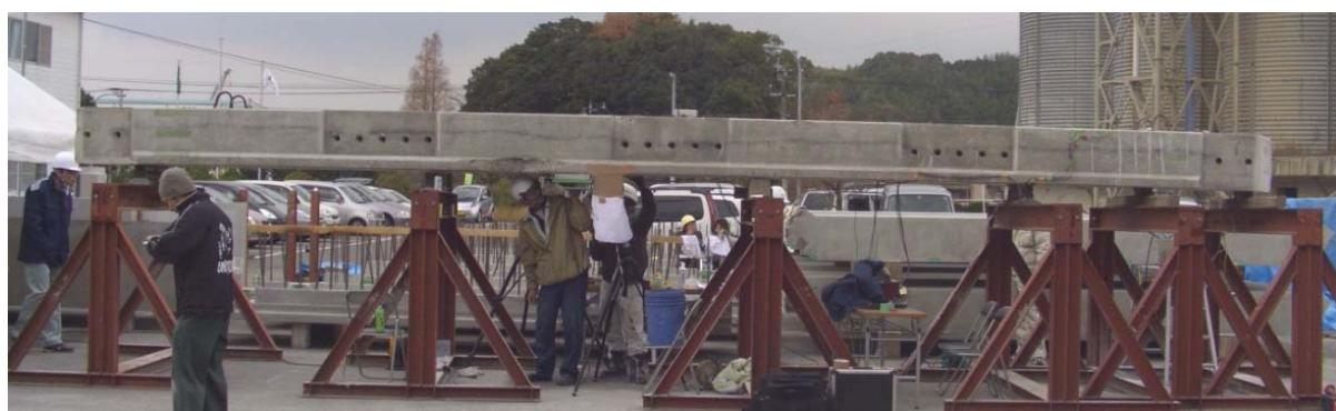
写真-5.4.1 プレテンション桁全景
