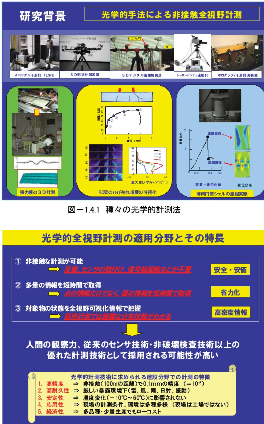
図-1.4.2 光学的計測法の建設工学への適用分野とその特長
