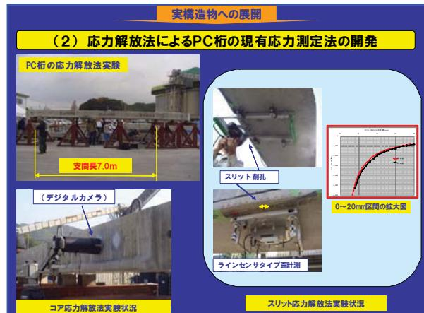
図-1.4.3 光学的計測器の開発と現場計測
