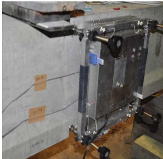
写真-4.2.3 スキャナ装置設置状況
