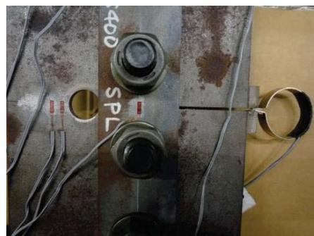
図-40 クリップ変位計設置位置概要
