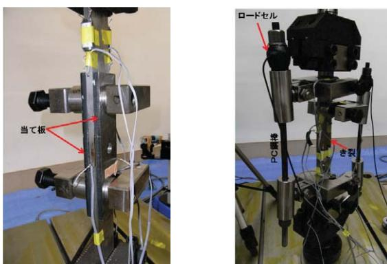
(a) 当て板補修 (RS-90) (b) プレストレス補修 (RP-10)
