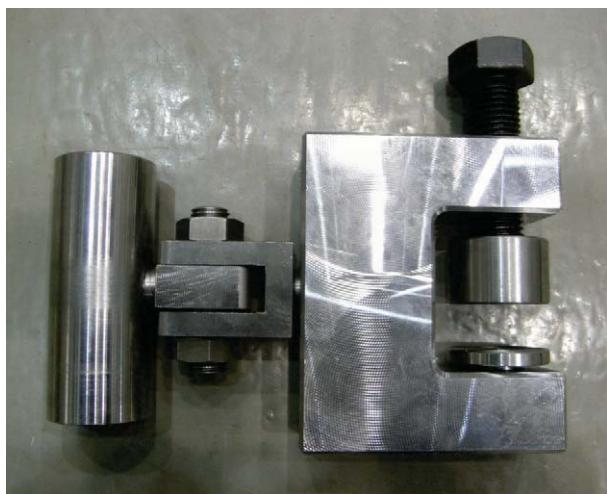
図-1 高性能万力の概要
