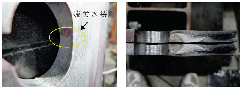
(a) き裂発生 (b) 破断後
