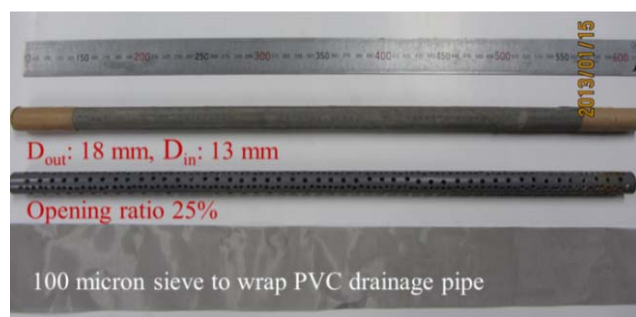
図 2 - 2 8 実験で用いた排水管模型
