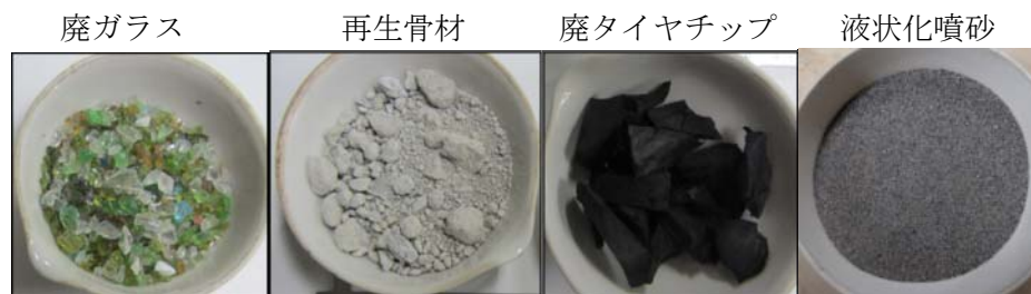
図 2－2 実験に用たリサイクル埋め戻し材料
