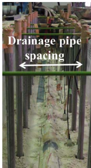
図 3-30 両側に設置された 排水管内に位置する埋設管の様子
