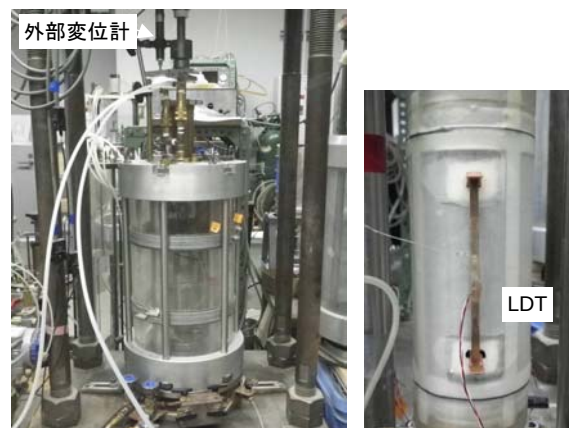
図 4-1-2 外部変位計と LDT の設置位置
