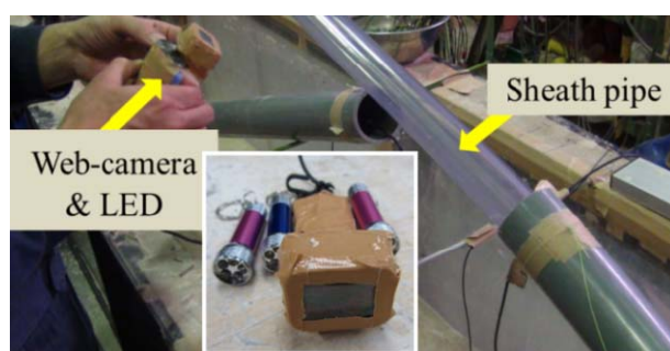
図3-5-3 埋設管模型に設置したビデオカメラとLEDランプ
