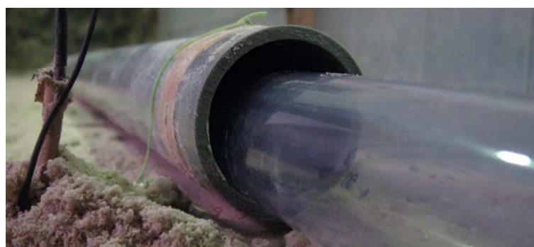
図3-5-2 埋設管模型に挿入されたシース管模型
