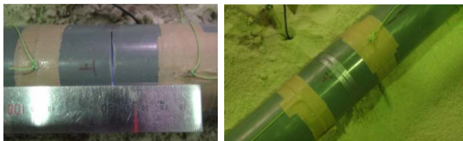
図3-5-1 2本の埋設管模型の接続部
