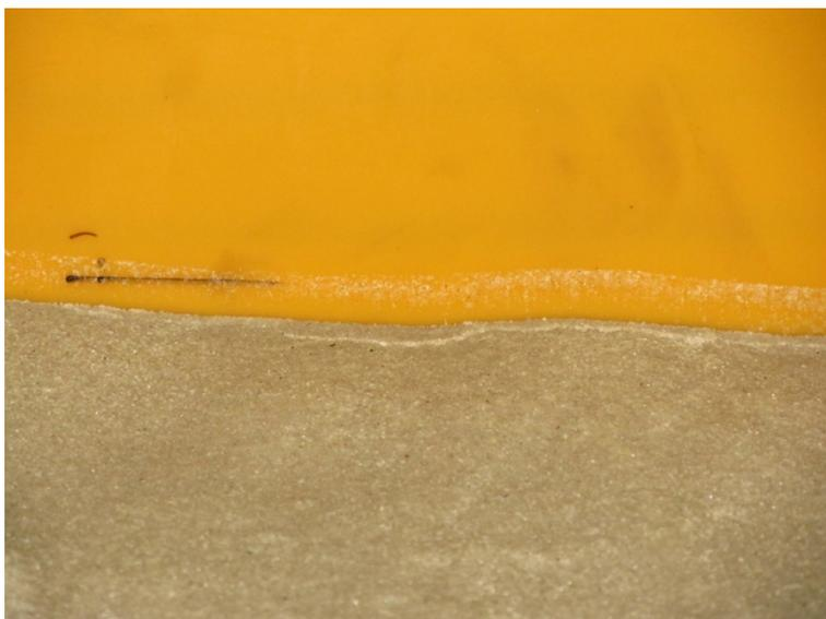
写真 3.1.8 地表面の沈下の状況（砂がうっすら土槽に付着している）
