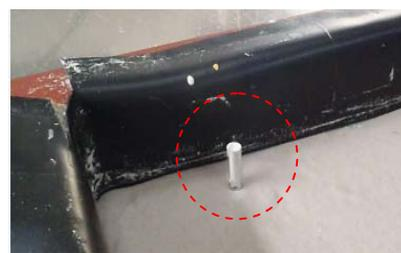
図 3.2.8 ピエゾ管（上図）とその設置状態（下図）
