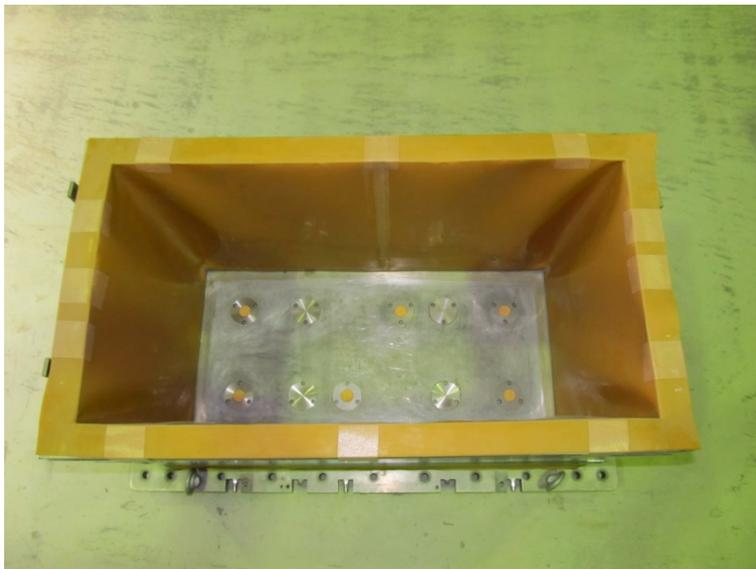
写真 3.1.2 土槽底面のポーラスストーン
