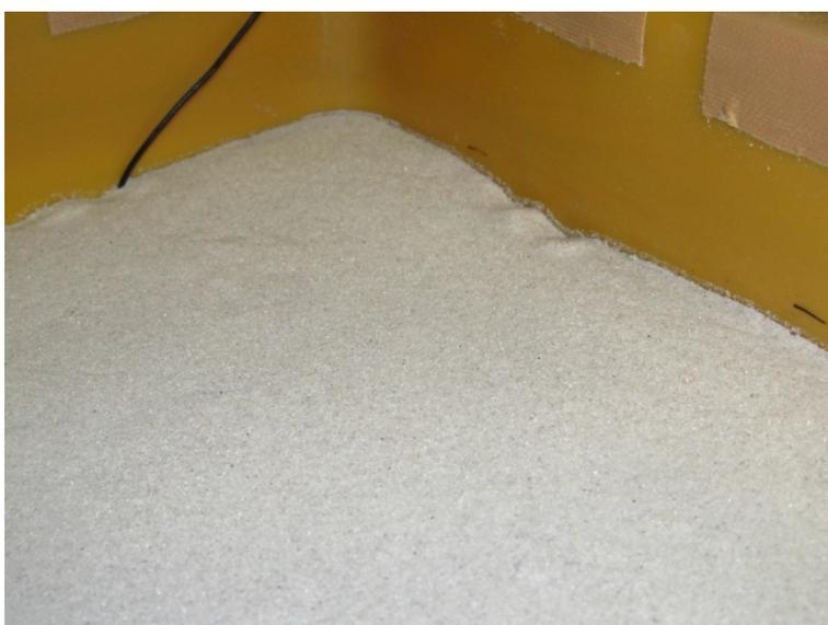
写真 3.1.13 実験後の状況（土槽壁近傍、砂のつき具合で沈下がわかる）
