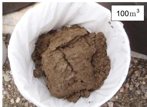
写真-3.52 脱水フロック (袋詰め脱水：7次処理後)
