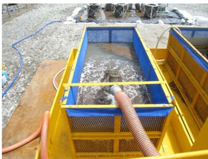
写真-3.34 フロック脱水状況（ボックス型）
