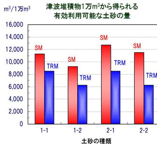
図-5.12 分級後の土砂量の比較 (SM と TRM)
