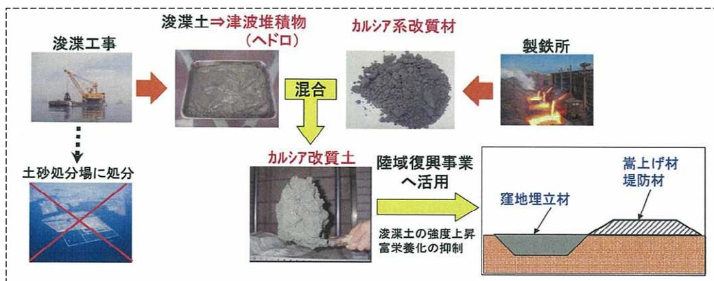
カルシア改質土とは、泥土(ヘドロ)とカルシア系改質材(転炉系製鋼スラグ)を混合させ、水硬性強度付加などの土砂性状の改良・改質された土質材料である。
