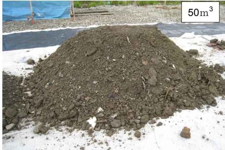
写真-3.46 粒径20mm～100mmの礫（2次処理後；がれきやごみが混入）
