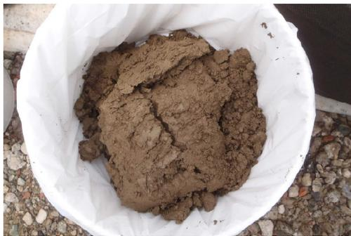
凝集フロック（簡易脱水後 w=150%）**100m<sup>3</sup>**
