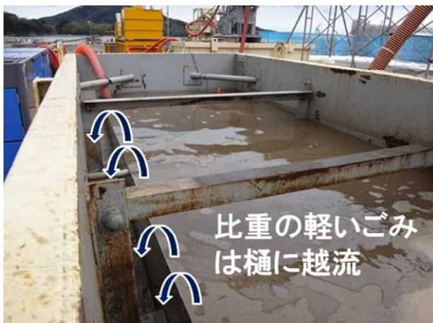
写真-3.20 浮遊ごみの攪拌槽での越流部
