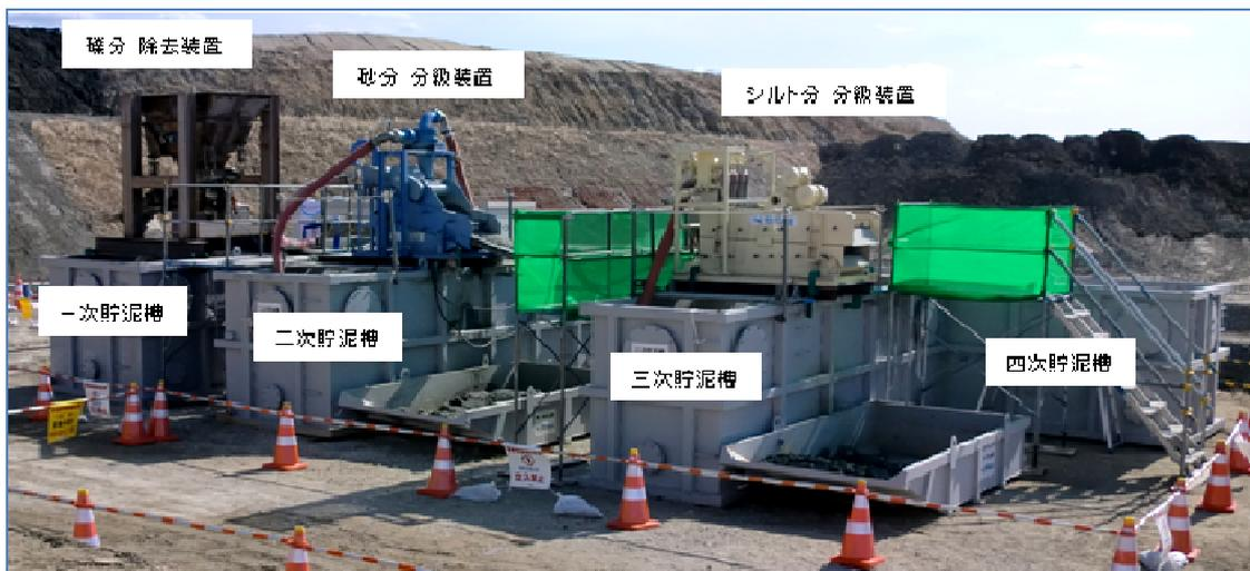
写真-2.4 ソイルセパレータ・マルチ工法全体および構成（実績 1：20m<sup>3</sup>/hr 級）
