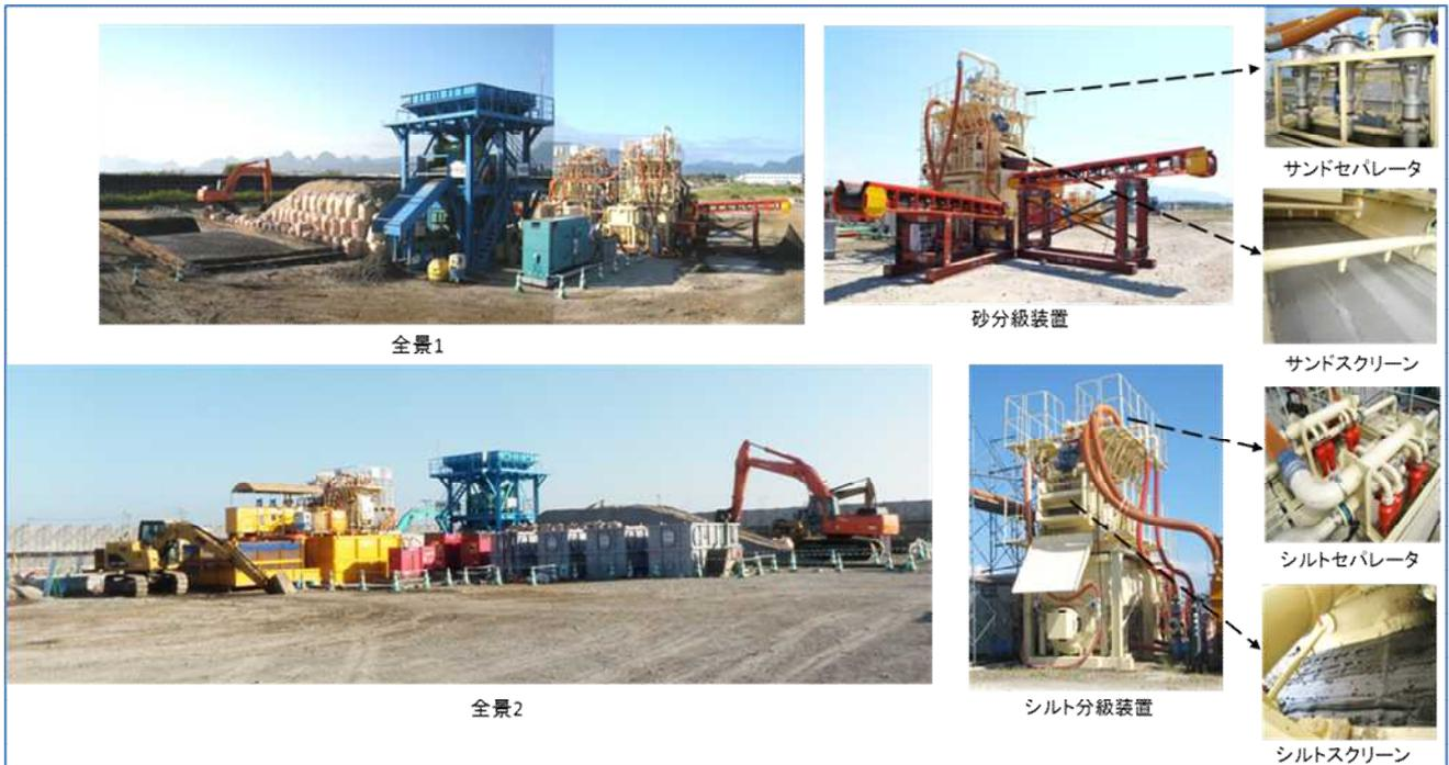
写真-2.7 ソイルセパレーター・マルチ工法全体および構成（実績 2；70m<sup>3</sup>/hr 級）
