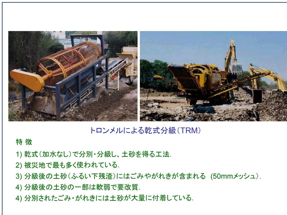
図-5.8 トロンメルによる津波堆積物処理の特徴
