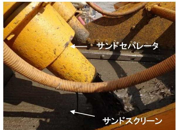
写真-3.27 サンドセパレータによる分級状況
