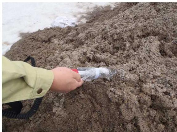
写真-3.55 空間線量測定状況（分級後細砂・シルト）
