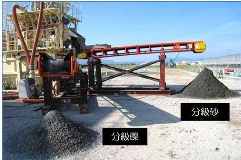
写真-2.11 砂分級装置（実績 2；70m<sup>3</sup>/hr 級）
