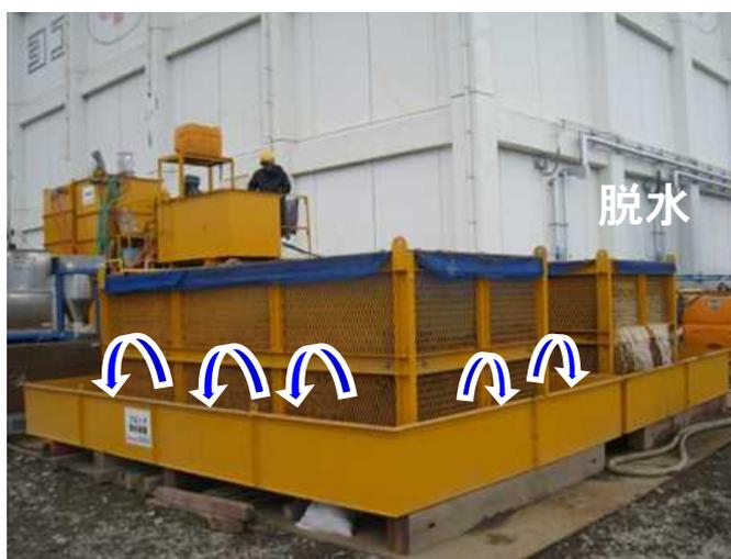
写真-3.33 フロック脱水装置（ボックス型）
