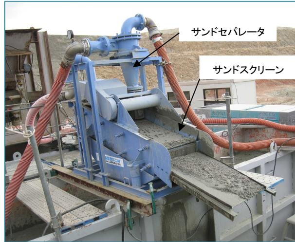
写真-2.5 サンドセパレータ、サンドスクリーン（事例1；20m<sup>3</sup>/hr 級）
