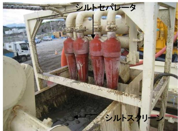
写真-3.29 シルトセパレータによる分級状況
