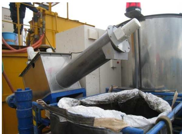
写真-3.38 フロック脱水状況（スクリュウ型）
