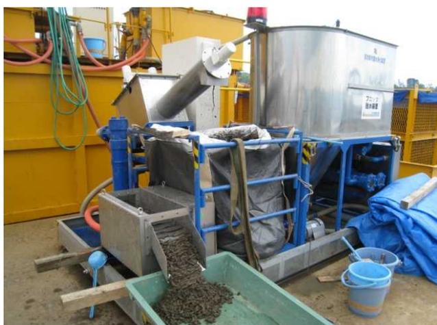
写真-3.36 連続式フロック脱水装置
