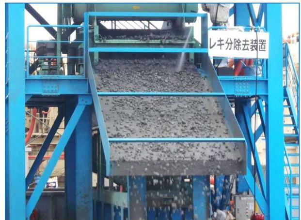
写真-2.9 礫分除去；実績 2；70m<sup>3</sup>/hr 級）
