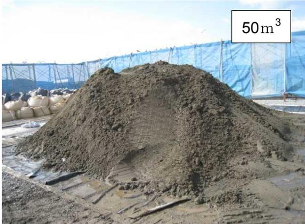
写真-3.49 細砂、シルト-1 (5次処理後：遠影)
