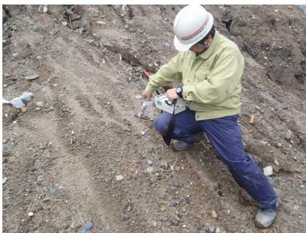
写真-3.53 空間線量測定状況（津波堆積物：処理・運搬前）
