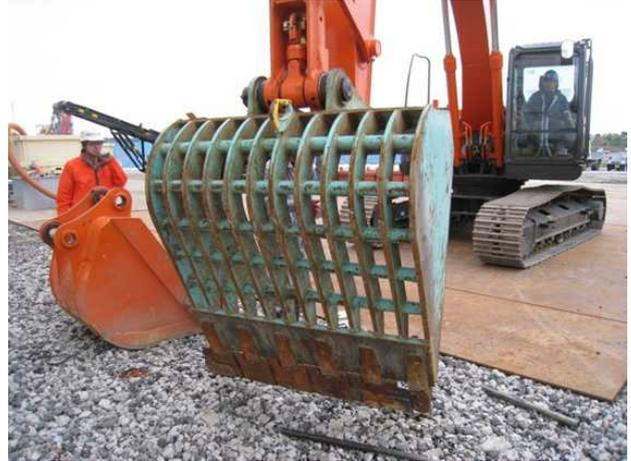
写真-3.9 スケルトンバケット (100mm×150mm)
