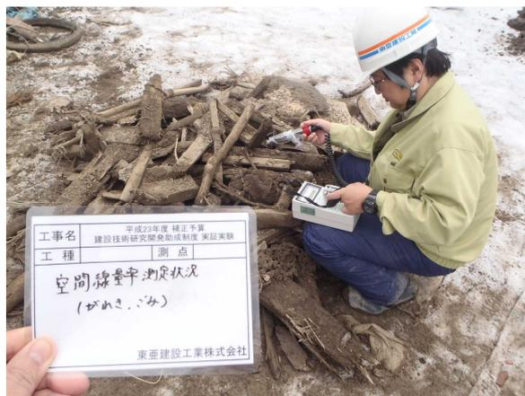
写真-3.54 空間線量測定状況（分級後がれき）
