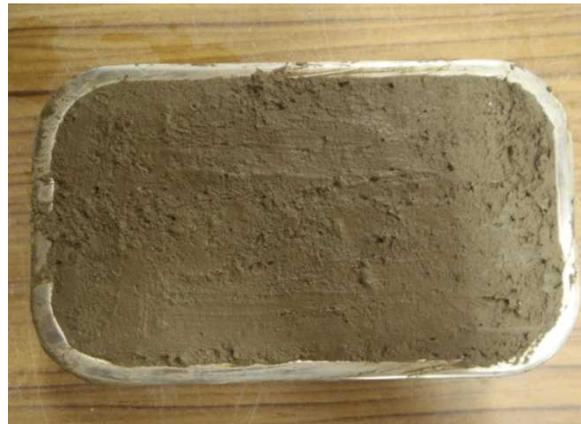
写真-4.2 ステンレス容器への充填完了
