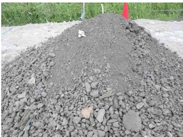
写真-62 ダンプアップ後セメント混合物
