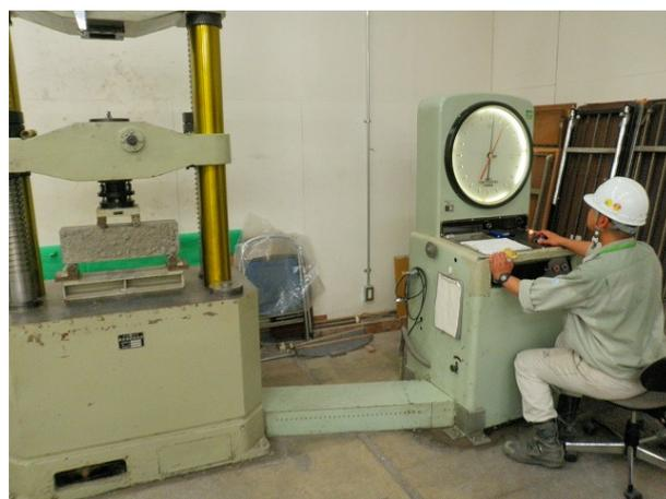
写真-14 曲げ強度試験状況
