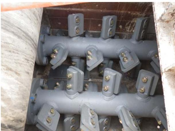
写真-60 混合機内部 2軸パドルミキサ
