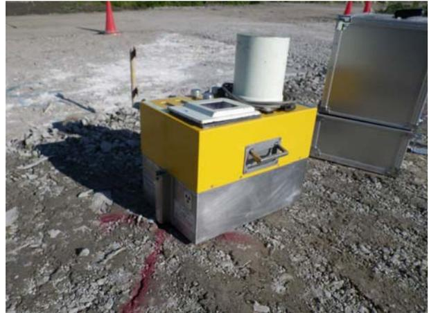
写真-65 RI 密度試験計測状況
