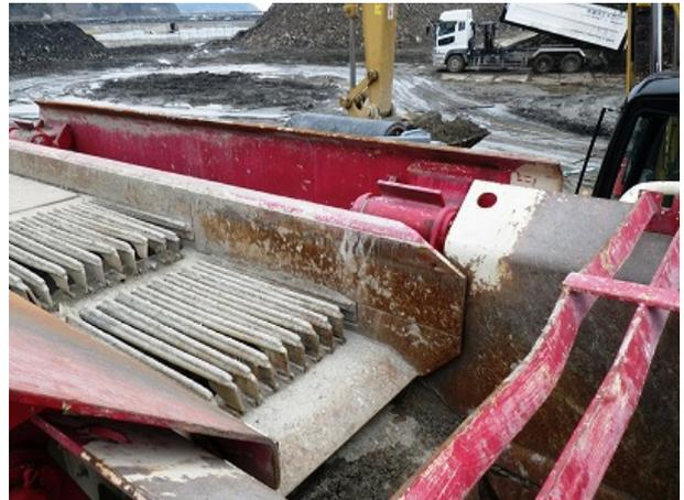
写真-4 破碎機がれき投入口部分
