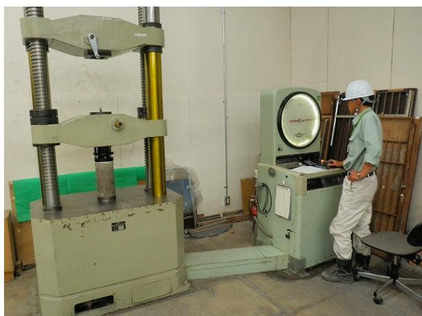
写真-13 圧縮強度試験状況
