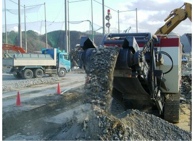
写真-8 破砕機からのがれき排出状況
