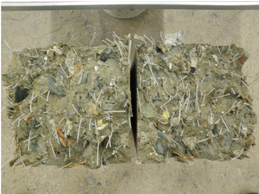
写真-51 PP 繊維 1vol%混入 (C=150kg/m<sup>3</sup>) の曲げ試験後の破断面
