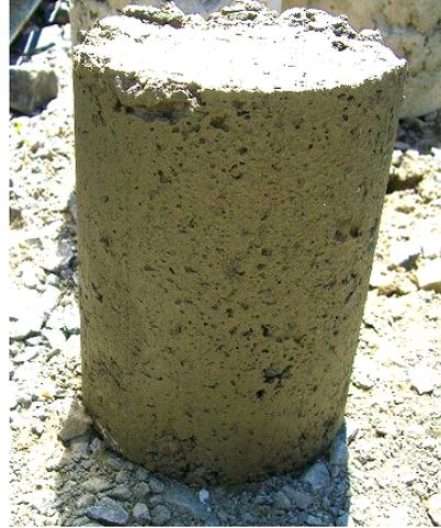
大型ミキサによる転圧実験時の性状
