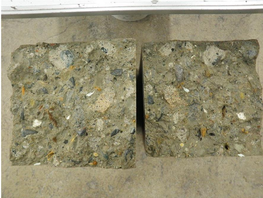
写真-50 セメント硬化体 (C=150kg/m<sup>3</sup>) の曲げ試験後の破断面
