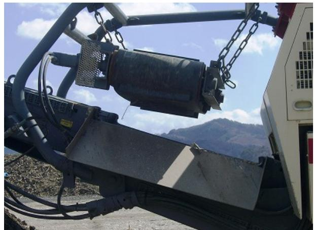
写真-6 破碎機磁選装置部分
