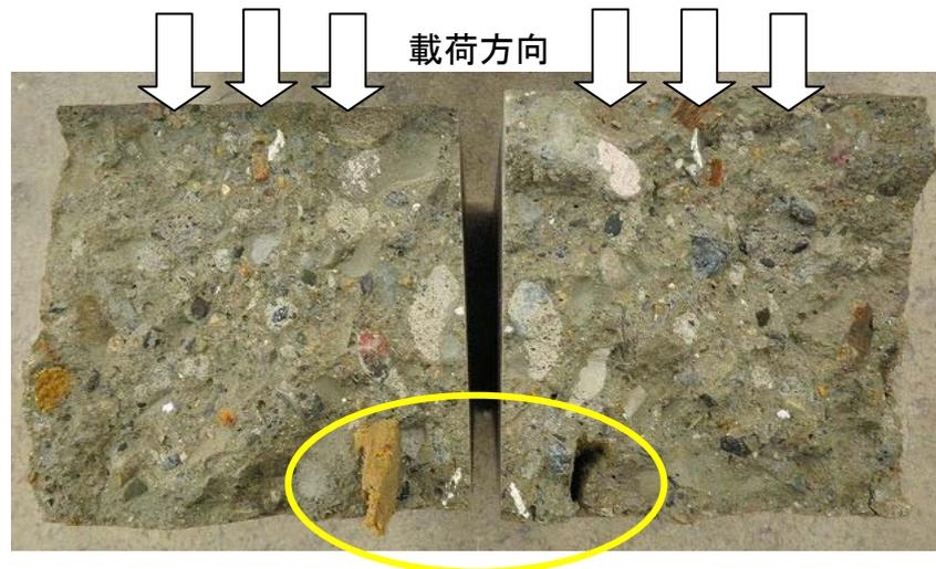
写真-49 特異点と判断したセメント硬化体の曲げ試験後の断面
