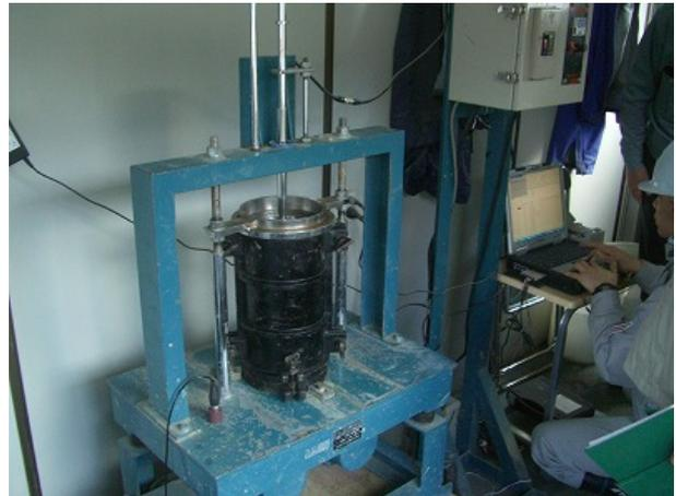
写真-12 締固め性試験状況
