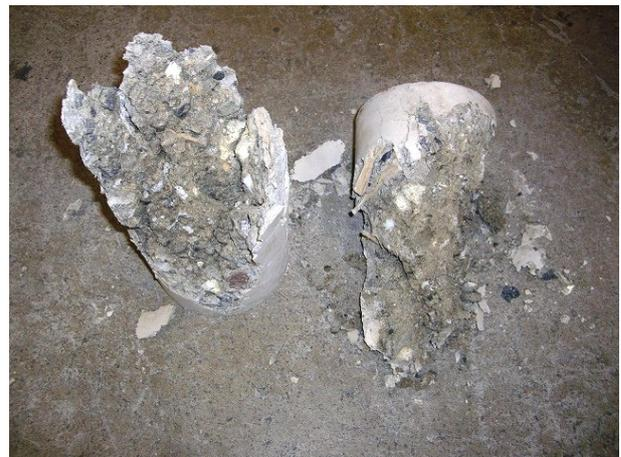
写真-46 コンクリートがれき圧縮試験供試体の載荷後断面
