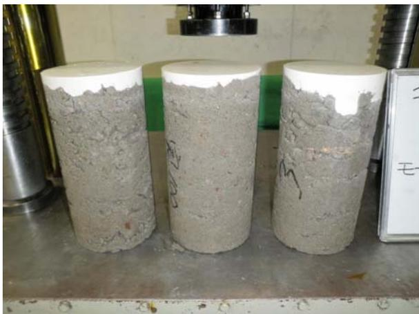
写真-76 Case1, 2 配合 2 振動締固め供試体
