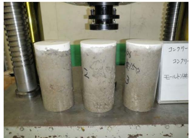
写真-77 Case3, 4 配合 1 振動締固め供試体
