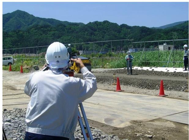
写真-23 沈下量計測状況
