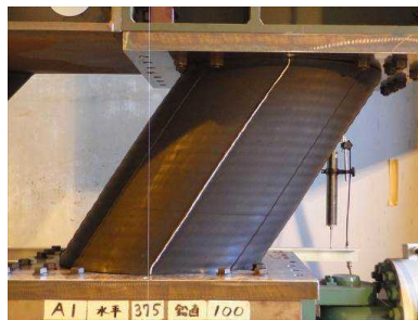
図 1.38 A1 軸力下の水平載荷実験結果 ( \delta_H=\pm 375\text{mm} , N=980\text{kN} )
