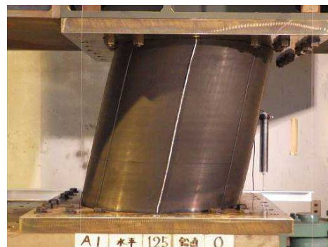
図 1.19 A1 無軸力下の水平載荷実験結果 ( \delta_H=\pm 125\text{mm} )
