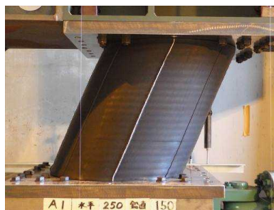
図 1.35 A1 軸力下の水平載荷実験結果 ( \delta_H=\pm 250\text{mm} , N=1470\text{kN} )
