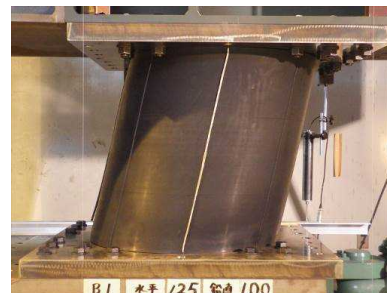
図 1. 42 B1 軸力下の水平載荷実験結果 ( \delta_H=\pm 125\text{mm} , N=980\text{kN} )
