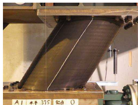
図 1.21 A1 無軸力下の水平載荷実験結果 ( \delta_H=\pm 375\text{mm} )
