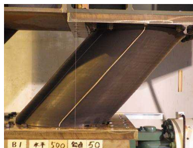
図 1. 53 B1 軸力下の水平載荷実験結果 ( \delta_H=\pm 500\text{mm} , N=490\text{kN} )
