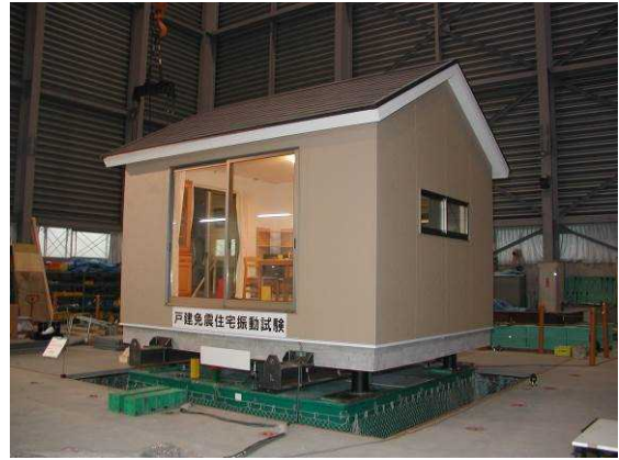
写真 1.1 小型の積層ゴム支承における座屈安定性
