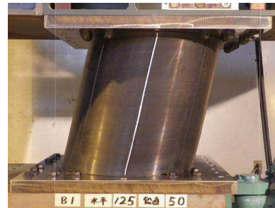
図 1. 41 B1 軸力下の水平載荷実験結果 ( \delta_H=\pm 125\text{mm} , N=490\text{kN} )
