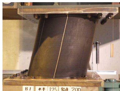
図 1. 44 B1 軸力下の水平載荷実験結果 ( \delta_H=\pm 125\text{mm} , N=1960\text{kN} )
