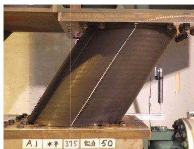
図 1.37 A1 軸力下の水平載荷実験結果 ( \delta_H=\pm 375\text{mm} , N=490\text{kN} )
