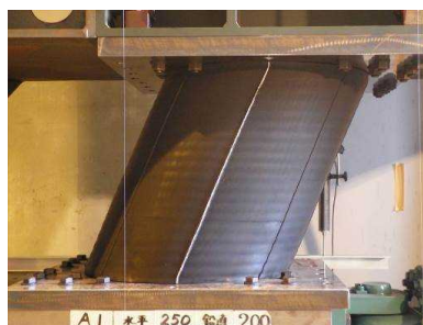
図 1.36 A1 軸力下の水平載荷実験結果 ( \delta_H=\pm 250\text{mm} , N=1960\text{kN} )
