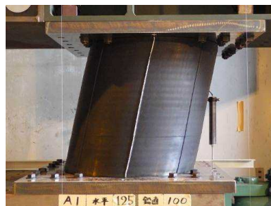
図 1. 30 A1 軸力下の水平載荷実験結果 ( \delta_H=\pm 125\text{mm} , N=980\text{kN} )
