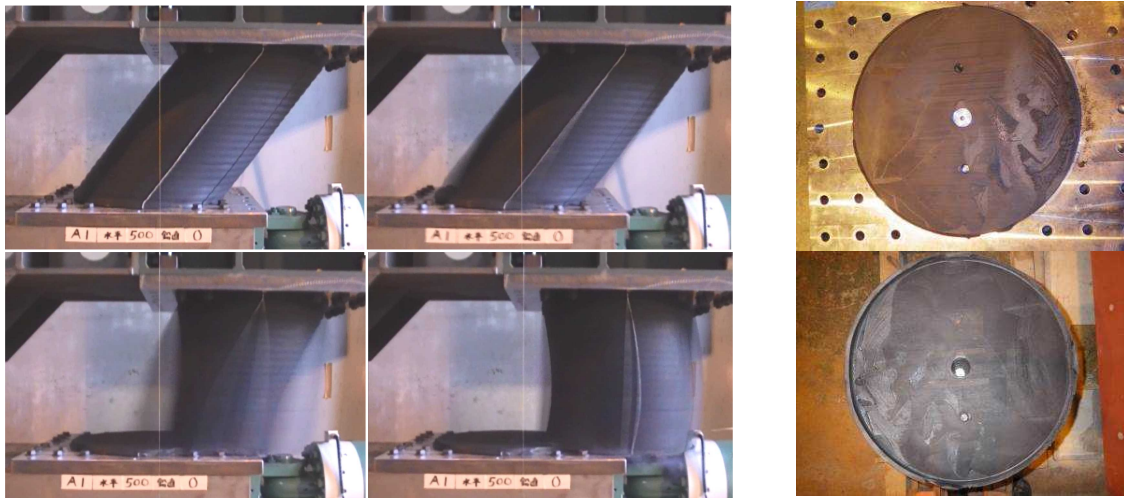
写真 1.5 破断時 (A1 無軸力下の水平載荷実験結果 ( \delta_H=439\text{mm} , N=0\text{kN} )) (写真①～④は、映像のコマ送り画像)
