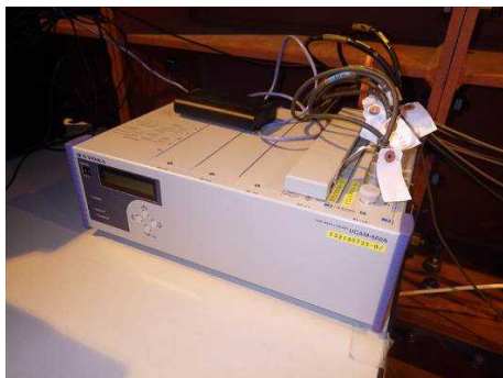
データロガー（共和電業製：UCAM-550A）
