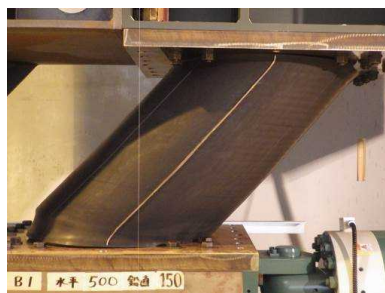
図 1.55 B1 軸力下の水平載荷実験結果 ( \delta_H=\pm 500\text{mm} , N=1470\text{kN} ) ※500mm で破断
