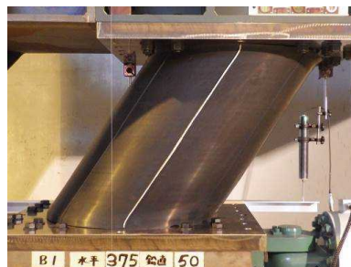
図 1. 49 B1 軸力下の水平載荷実験結果 ( \delta_H=\pm 375\text{mm} , N=490\text{kN} )
