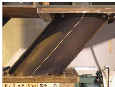
図 1.26 B1 無軸力下の水平載荷実験結果 ( \delta_H = \pm 500\text{mm} )
