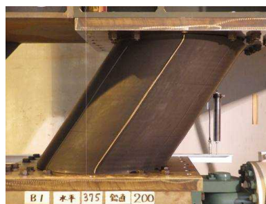
図 1. 52 B1 軸力下の水平載荷実験結果 ( \delta_H=\pm 375\text{mm} , N=1960\text{kN} )
