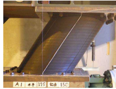
図 1. 39 A1 軸力下の水平載荷実験結果 ( \delta_H=\pm 375\text{mm} , N=1470\text{kN} )
