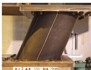
図 1. 48 B1 軸力下の水平載荷実験結果 ( \delta_H=\pm 250\text{mm} , N=1960\text{kN} )
