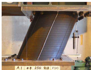
図 1.34 A1 軸力下の水平載荷実験結果 ( \delta_H=\pm 250\text{mm} , N=980\text{kN} )
