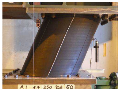
図 1. 33 A1 軸力下の水平載荷実験結果 ( \delta_H=\pm 250\text{mm} , N=490\text{kN} )
