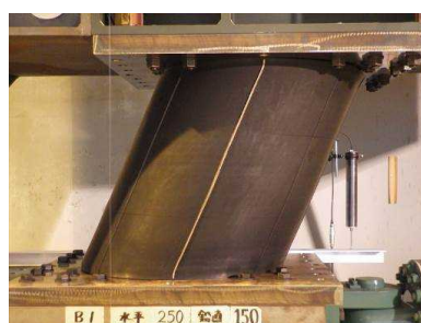
図 1. 47 B1 軸力下の水平載荷実験結果 ( \delta_H=\pm 250\text{mm} , N=1470\text{kN} )
