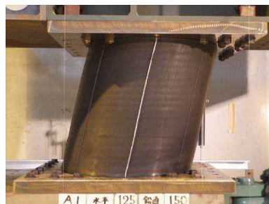
図 1. 31 A1 軸力下の水平載荷実験結果 ( \delta_H=\pm 125\text{mm} , N=1470\text{kN} )
