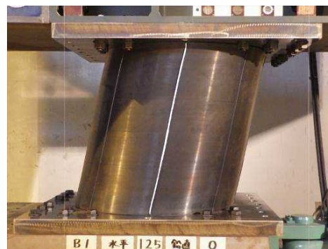
図 1.23 B1 無軸力下の水平載荷実験結果 ( \delta_H = \pm 125\text{mm} )
