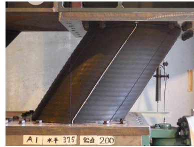
図 1. 40 A1 軸力下の水平載荷実験結果 ( \delta_H=\pm 375\text{mm} , N=1960\text{kN} )
