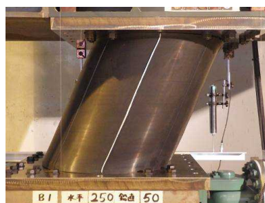
図 1. 45 B1 軸力下の水平載荷実験結果 ( \delta_H=\pm 250\text{mm} , N=490\text{kN} )
