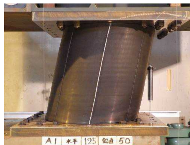
図 1. 29 A1 軸力下の水平載荷実験結果 ( \delta_H=\pm 125\text{mm} , N=490\text{kN} )
