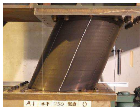
図 1.20 A1 無軸力下の水平載荷実験結果 ( \delta_H=\pm 250\text{mm} )
