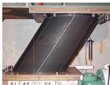
図 1. 51 B1 軸力下の水平載荷実験結果 ( \delta_H=\pm 375\text{mm} , N=1470\text{kN} )
