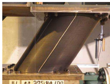
図 1. 50 B1 軸力下の水平載荷実験結果 ( \delta_H=\pm 375\text{mm} , N=980\text{kN} )
