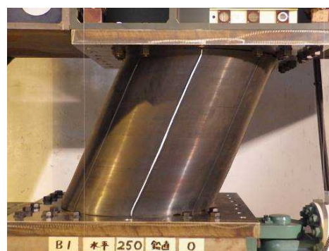
図 1.24 B1 無軸力下の水平載荷実験結果 ( \delta_H = \pm 250\text{mm} )
