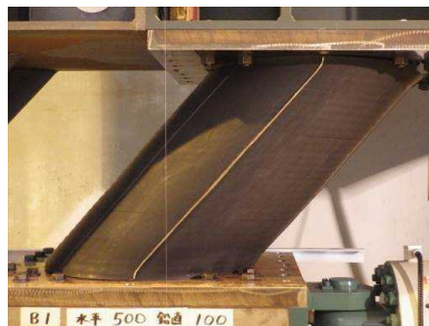
図 1.54 B1 軸力下の水平載荷実験結果 ( \delta_H=\pm 500\text{mm} , N=980\text{kN} )
