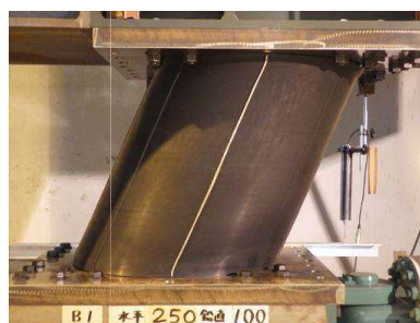
図 1. 46 B1 軸力下の水平載荷実験結果 ( \delta_H=\pm 250\text{mm} , N=980\text{kN} )
