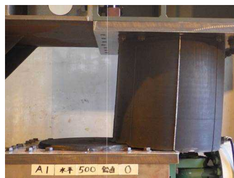
図 1.22 A1 無軸力下の水平載荷実験結果 ( \delta_H=\pm 500\text{mm} ) ※439mm で破断
