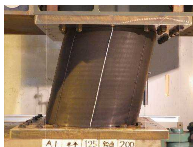
図 1. 32 A1 軸力下の水平載荷実験結果 ( \delta_H=\pm 125\text{mm} , N=1960\text{kN} )
