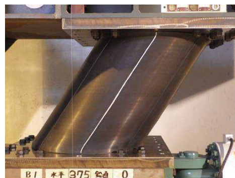
図 1.25 B1 無軸力下の水平載荷実験結果 ( \delta_H = \pm 375\text{mm} )
