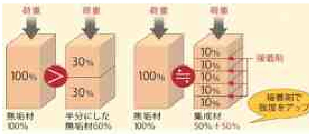
図 6.4.3 集成材の仕組み
