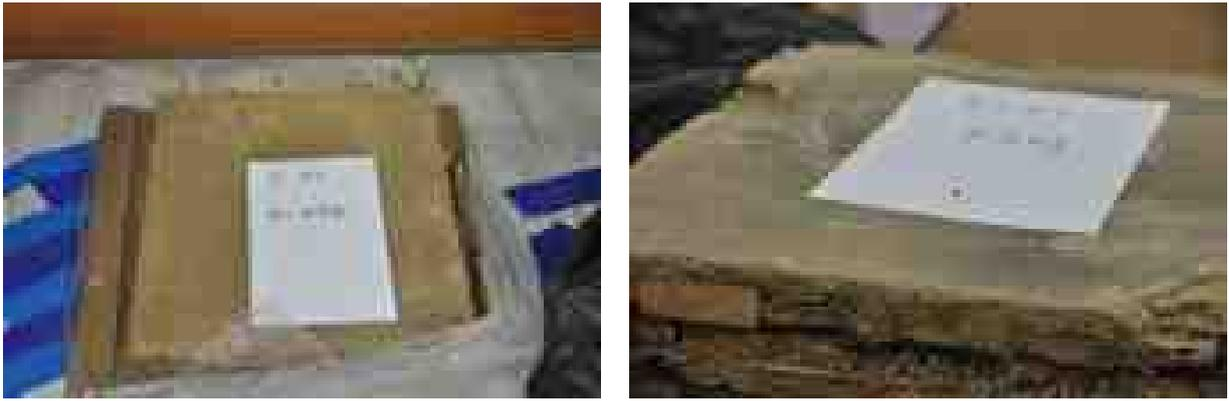
写真 2.3.16 解体時に取り出した土壁の標本(約 500mm 角)
