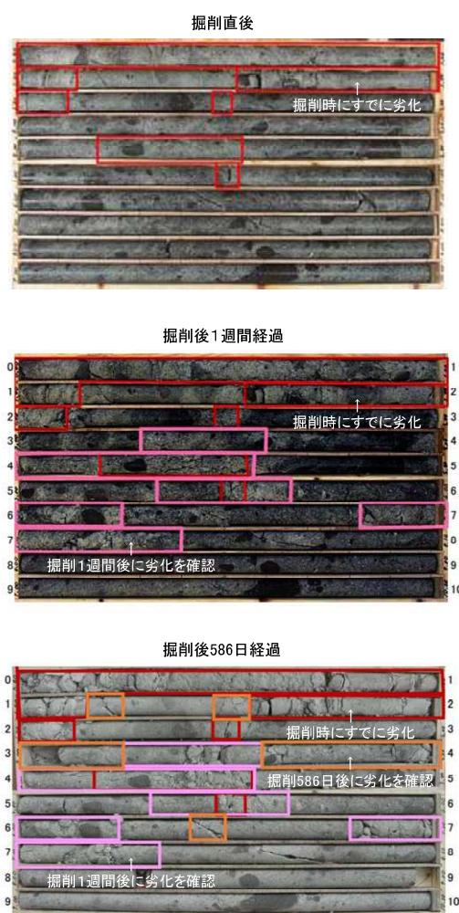
図-5 時間経過に伴うボーリングコアの劣化
