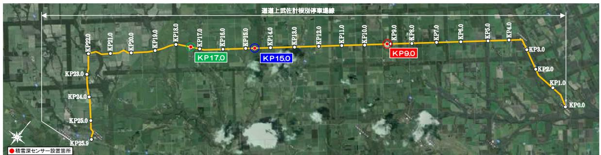
図 2-1-2 積雪深センサー位置図(道道上武佐計根別停車場線)
