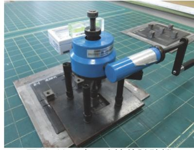
図-1.10 建研式接着試験機
