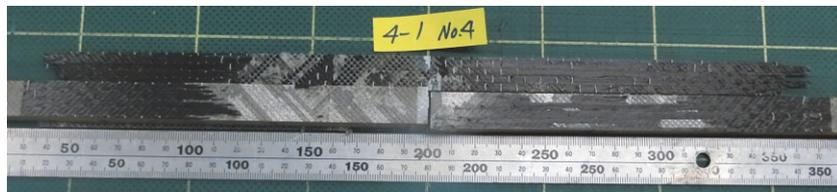
図-1.12 試験後の破壊状態
