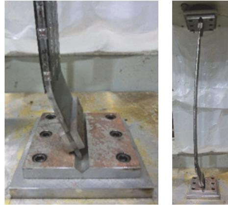
(a) CFRP 端部近傍の局部座屈 (b) 全体図
