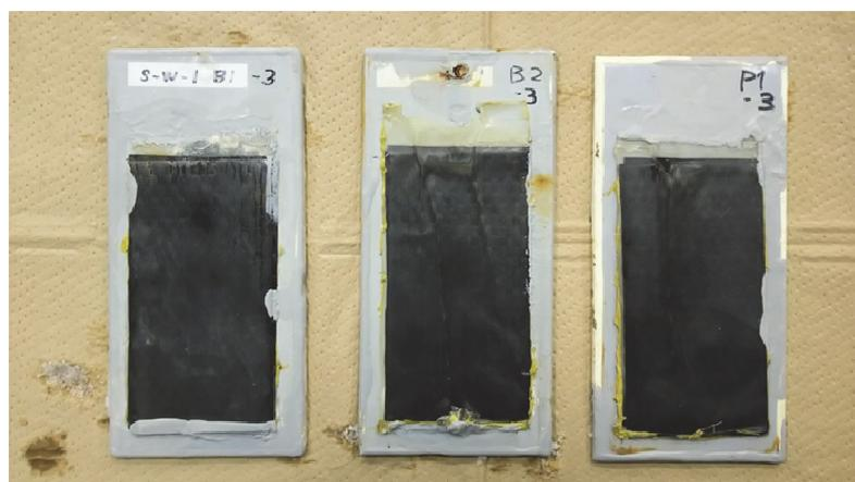
図-2.19 複合腐食サイクル試験（402サイクル）後の供試体の外観（左から、B1、B2、P1）
