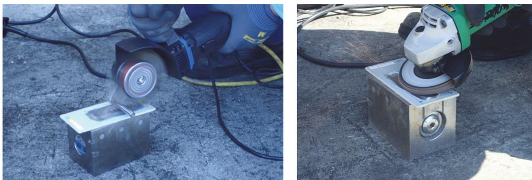
図-2.16 検討した素地調整方法(左:ブラスト面形成動力工具、右:ディスクサンダー)
