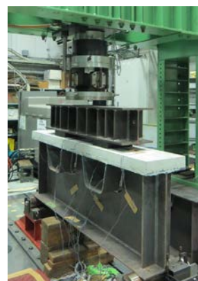
図-9 SFRC 舗装を敷設した鋼床板試験体の疲労試験
