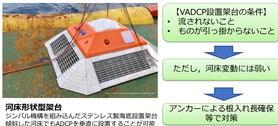
図-53 V-ADCP のトラブル対策案
