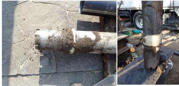
写真 4.5 捨てビット損傷（左；スクリュウ型、右；十字型）
