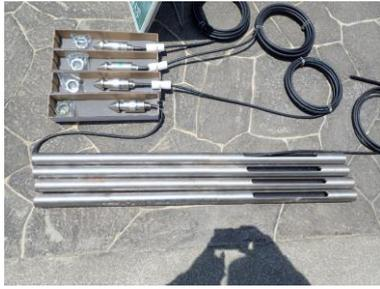
写真 4.1 地中間隙水圧計
