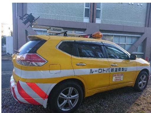
図 1.1 パトロール車両に画像計測ユニットを取り付けた様子
