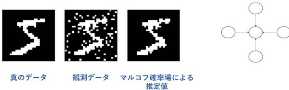
図 2.3 マルコフ確率場によるデータ内のノイズ除去例
