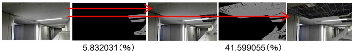
(結果) 棚の上部の変異が映り込むことで、天井の損傷にしては大きな数値が検知された。
