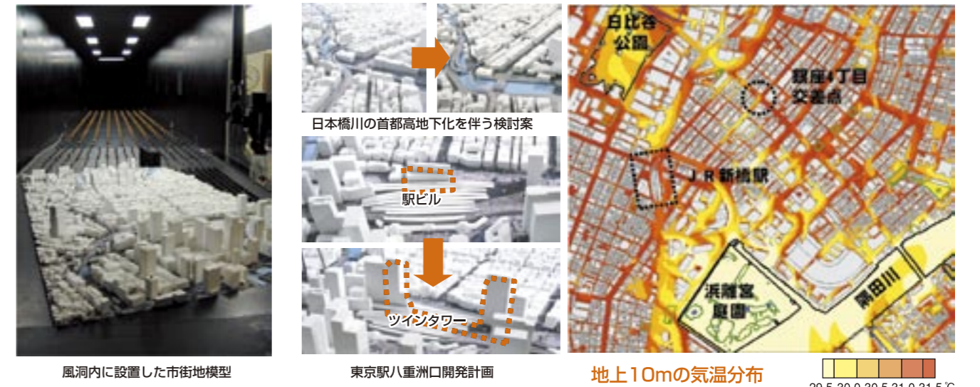
図 1 市街地モデルによる風洞実験（ケーススタディ）
